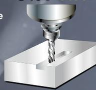
Tool  $\phi 16\text{mm} \times 4\text{T}$
