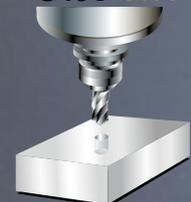
Tool  $\phi 44\text{mm} \times 2\text{T}$
